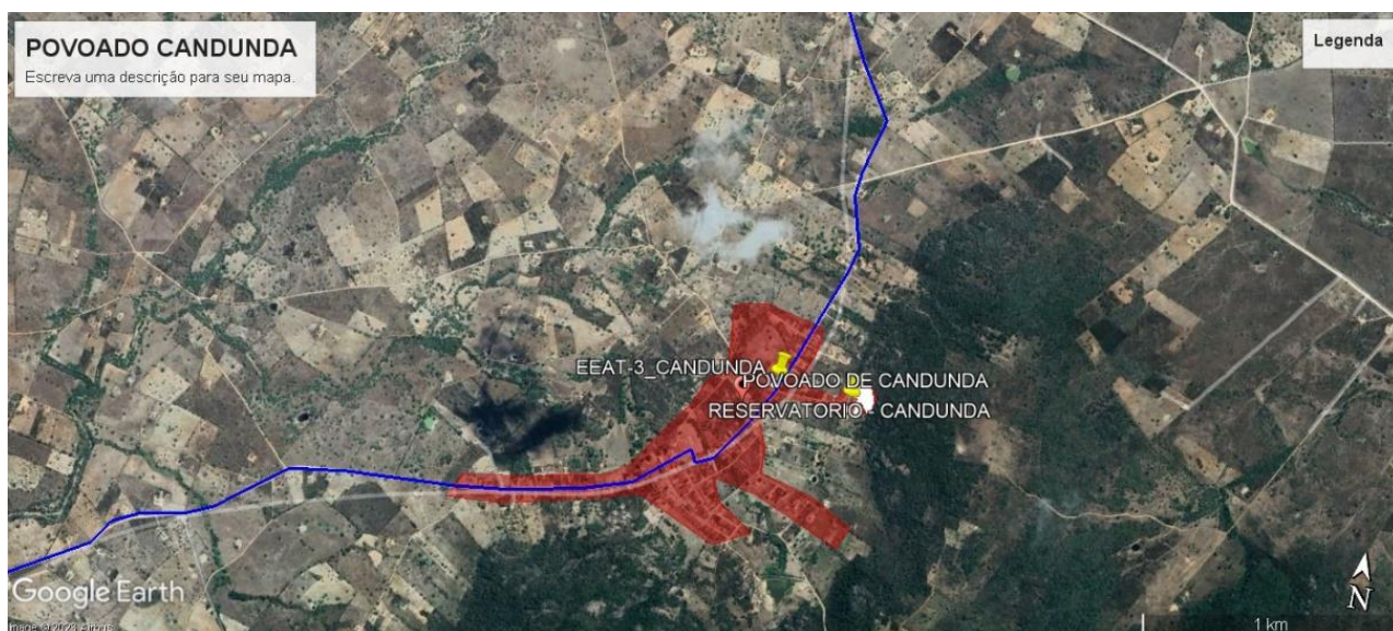
Figura 3 - Povoado Candunda (661487.00 m E de longitude e 8959806.00 m S de latitude em coordenadas UTM – 24L). No perímetro do povoado deverá ser instalado uma EEAT e uma Reservatório. Posteriormente, (cerca de 6,7km e 7,9km) estão previstas duas Travessias em linhas de drenagem com curso d' água efêmero. Fonte: Encibra.
